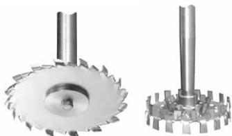
**Фрезерные мешалки** – высокоскоростные мешалки с зубчатым перемешивающим элементом. Рекомендуются для гомогенизации и диспергирования (измельчения) частиц в перемешиваемой жидкости. Могут использоваться в паре с пропеллерной или якорной мешалкой.
